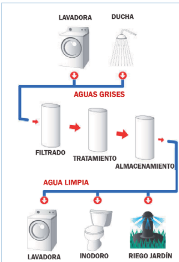
Esquema básico del ciclo de reutilización de aguas grises para el ámbito doméstico.
