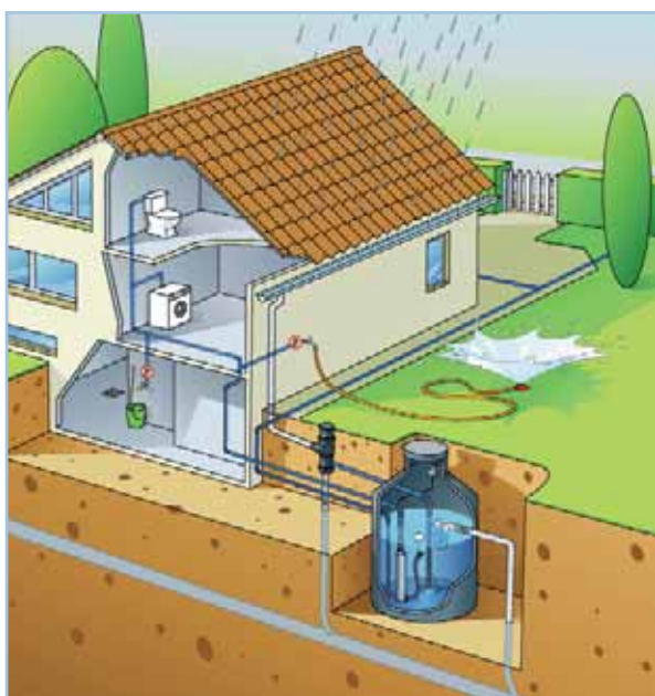
Esquema de un sistema de reutilización de aguas pluviales.
